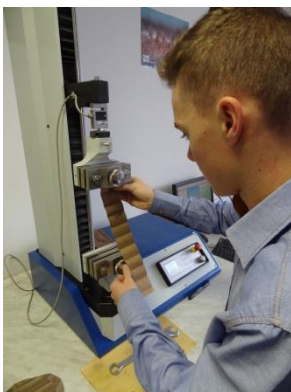
Obrázek 26: Měření pevnosti filtračního média - laboratoře ZVVZ-Enven Engineering. (Vlastní foto, 2015)
