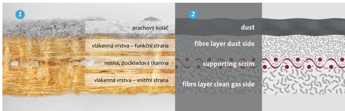
Obrázek 1: Příčný řez filtračním médiem – jehlovou plstí (MUSIL, 2012)
