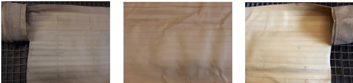
Obrázek 23, Obrázek 24, Obrázek 25 zleva: sada obrázků – horní, střední a spodní části filtračního elementu z vnitřní strany (Vlastní foto, 2015)
