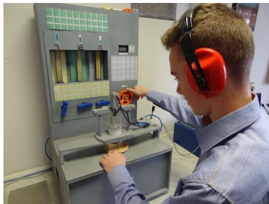
Obrázek 28: Měření prodyšnosti v laboratořích ZVVZ-Enven (Vlastní foto, 2015)
