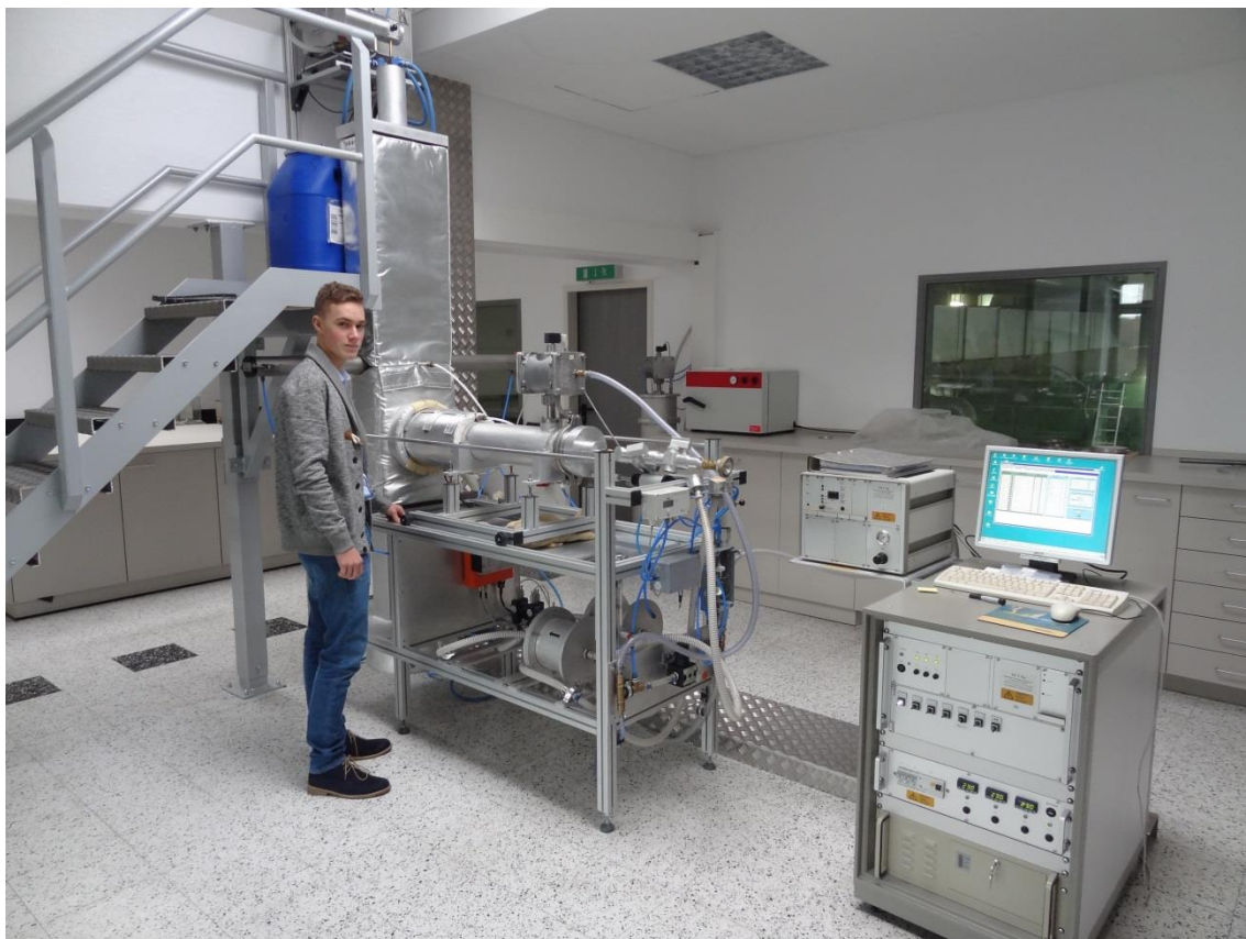
Obrázek 13: Testovací linka dle VDI/DIN 3926 - laboratoře R&D společnosti MGF Gutsche (Vlastní foto, 2015)
