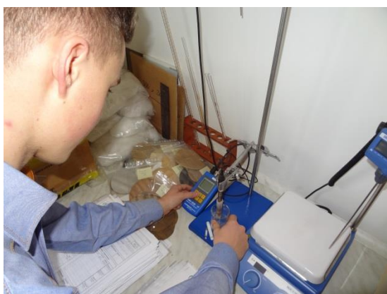
Obrázek 32: Měření pH výluhu filtračního média (Vlastní foto, 2015)
